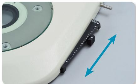
スライドレバーを前後に動かすだけの簡単操作。目盛り付きのため、再現も容易。OCC遮光板の挿入方向が前方から/後方からと二通りのため、コントラストの付き方を変えて観察ができます。
