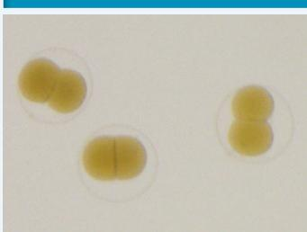
OCC 照明は透明な試料のコントラストを強調して観察することができます。
