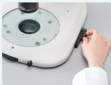
LED透過照明スタンドおよびファイバー透過照明スタンドは、OCC照明の陰影の付き方を簡単に調整できます。
