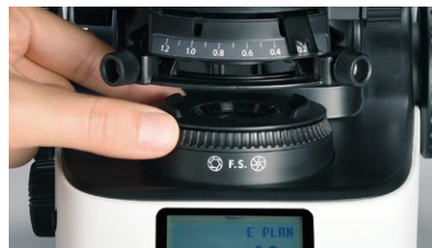
照明範囲が視野に外接するまで、視野絞りダイヤルを回します
