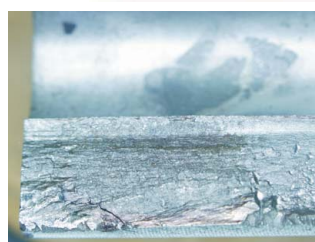
金属破断面4分割LED全面照射
