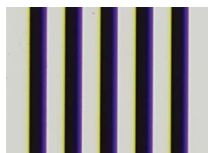
アポクロマートシステムによる色収差補正がされていない場合
