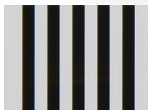
アポクロマートシステムによる色収差補正
