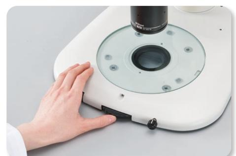
LED透過照明スタンドおよびファイバー透過照明スタンドは、観察作業中にフォーカス調整が手元のダイヤルで行えます。
