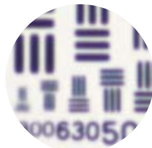
解像力チャート (SMZ1500+HR Plan Apo 1.6×対物レンズ)
